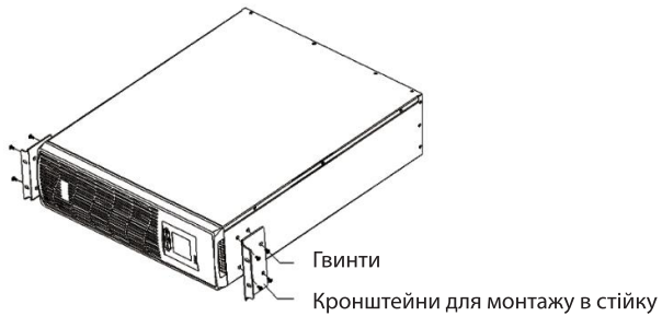
Мал. 3.2.4.3 Встановлення кронштейнів для монтажу в стійку
