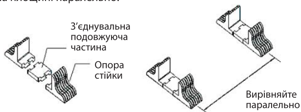
Мал. 3.2.4.2 Схема монтажу опорних елементів
