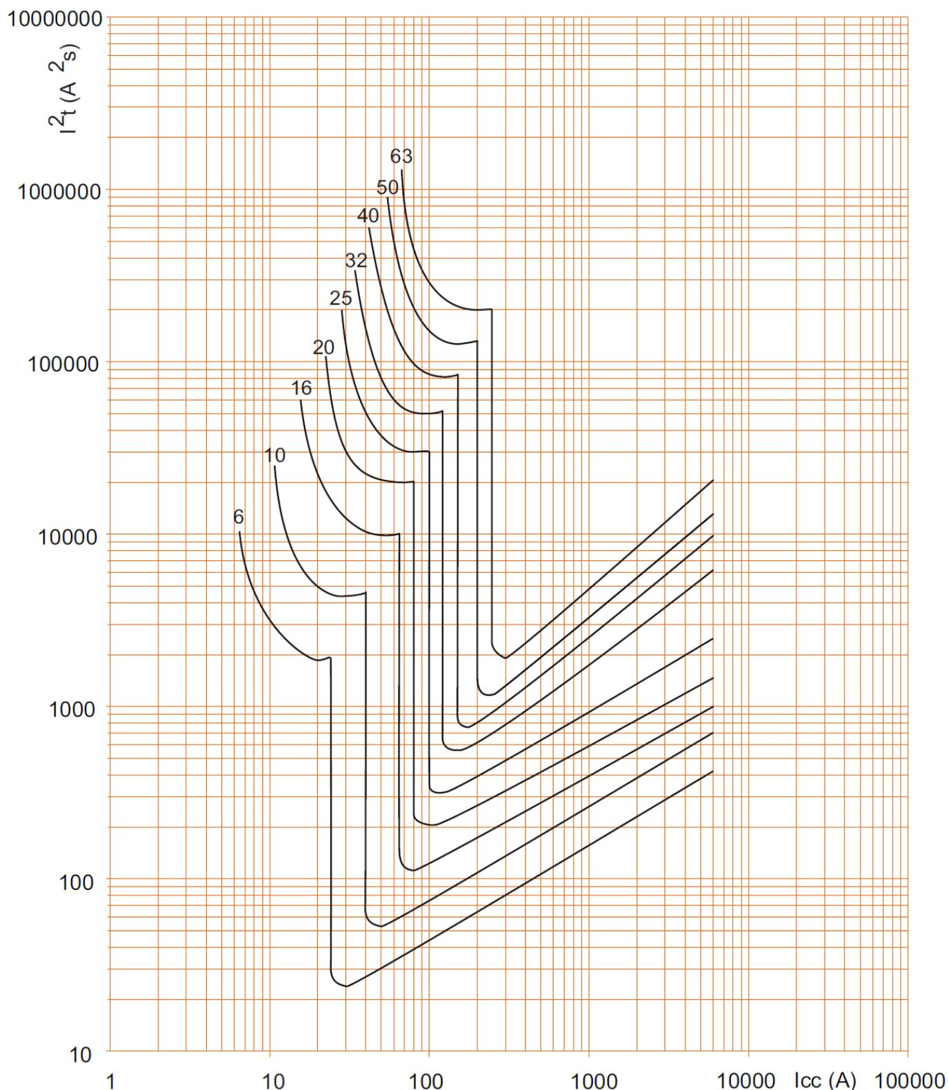
$I_{sc}$  = действующее значение расчётного тока симметричного короткого замыкания (кА).
