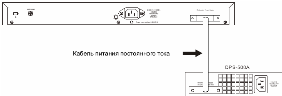
Рисунок 10 — Подключение DPS-500A к коммутатору
