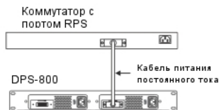
Подключение RPS, установленного в шасси DPS-800, к коммутатору
