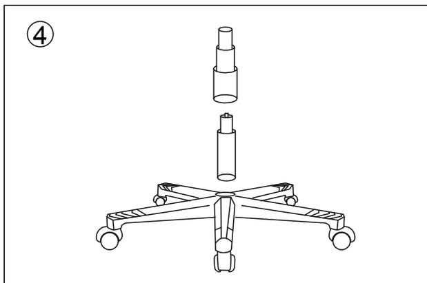
5. Установите собранное сиденье и спинку кресла на подставку. Для этого необходимо в отверстие на механизме регулирования вставить цилиндр пневматического подъемного механизма как показано на рис. 5.
