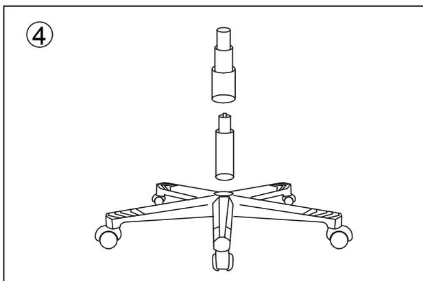
5. Встановіть зібране сидіння і спинку крісла на підставку. Для цього необхідно в отвір на механізмі регулювання вставити циліндр пневматичного підйомного механізму як показано на мал. 5.
