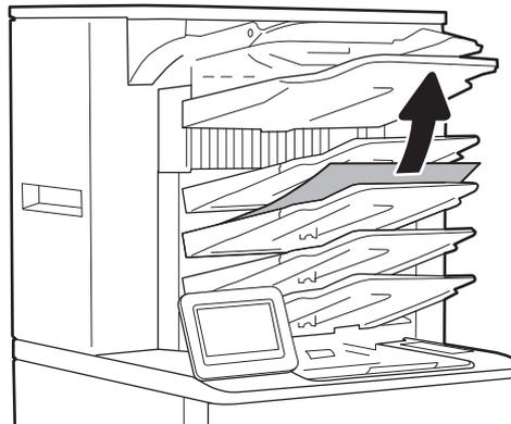
2. Откройте дверцу доступа к замятиям на задней стороне сшивателя/укладчика. Если замятую бумагу видно за дверцей доступа к замятиям, вытяните ее вверх.
