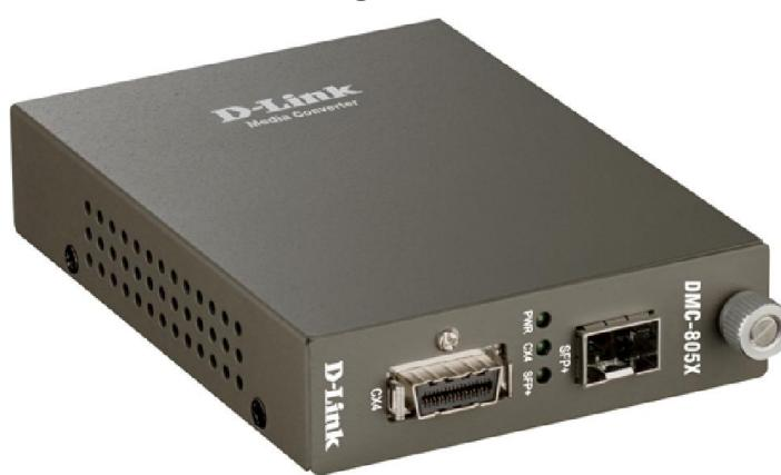
Медиаконвертер DMC-805X преобразует сигнал из стандарта 10G CX4 на сигнал 10G SFP+. DMC-805X оснащен слотом SFP+ для оптических трансиверов, выбираемых пользователем, и расширяет сетевое соединение для различных расстояний в зависимости от возможностей SFP+ трансивера. DMC-805X представляет собой высокопроизводительный медиаконвертер 10G, который позволяет увеличить расстояние для серверов, оснащенных сетевыми картами CX4 или старыми 10G коммутаторами с портами 10G CX4.
