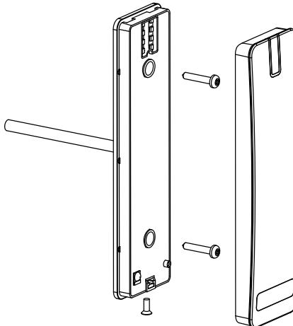
0. Для подключения кабеля под корпусом считывателя необходимо предусмотреть наличие небольшого углубления или отверстия диаметром 14 мм.
