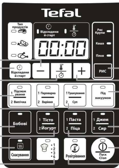
1. 17 клавіш: «Відкладений старт», «-», «Температура/Таймер», «Підсмажування/Випічка», «Пароварка/Варіння», «Бобові», «Тісто/Йогурт», «Збереження тепла/Скасування», «Мультишеф», «Пуск/Стоп», «Розігрівання», «Джем/сир», «Тушкування/Суп», «Рис/Крупи», «Каша», «Плов», «+». Під час натискання клавіші лунає звукове попередження.
