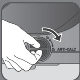
**CS** Znovu zcela našroubujte klobouček „odvápnění“ tak, aby byl vodotěsný, ale nepřetáhnout.
