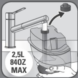
**CS** Svisle nakloňte spotřebič a vylijte vodu do dřezu.
