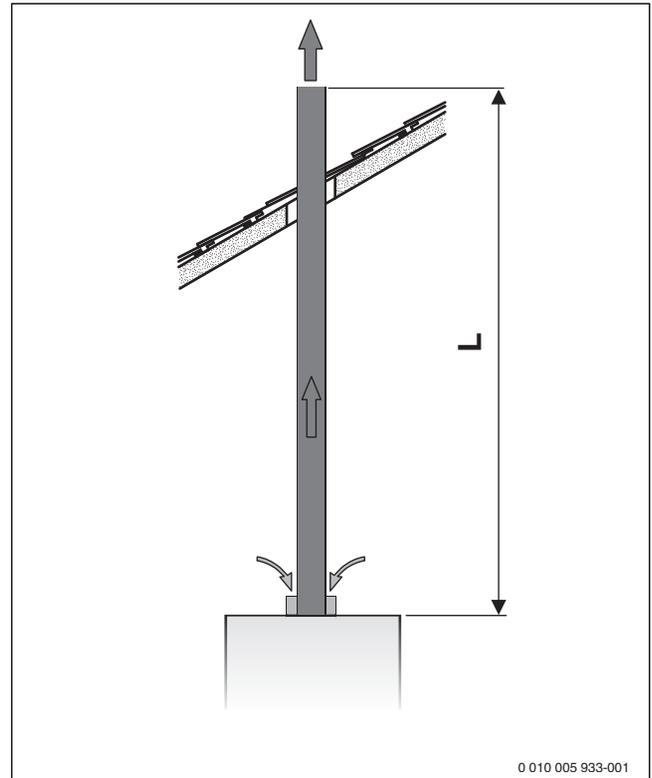
Рис. 5 Вертикальный отвод дымовых газов В<sub>22</sub>
