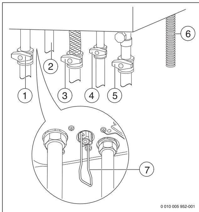
Рис. 16 Подключения газопровода и водяного контура (дополнительная комплектация)
