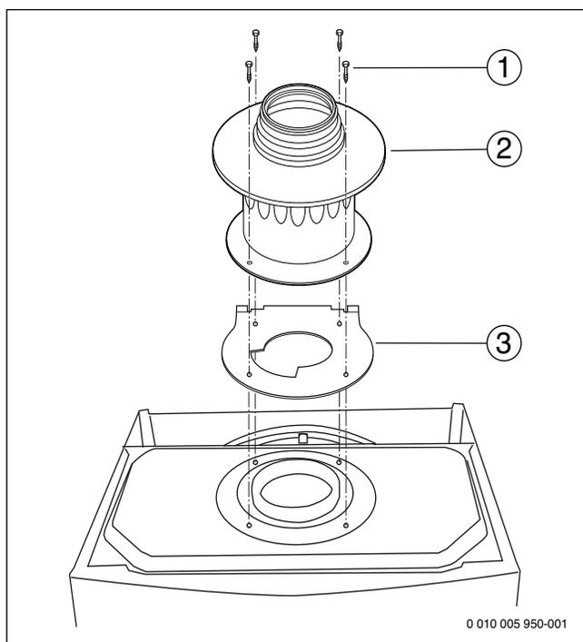
Рис. 15 При отводе дымовых газов В<sub>22</sub>: установите переходник и дроссельную диафрагму
