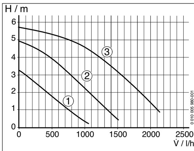
Рис. 25 Характеристики насоса отопительного контура
