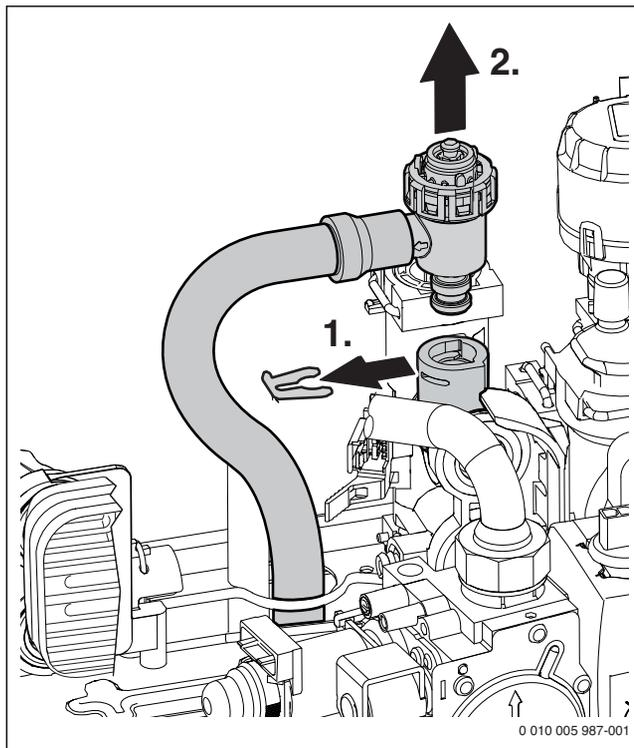
Рис. 30 Демонтаж предохранительного клапана (отопительного контура)
