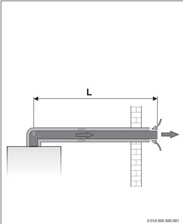
Рис. 6 Горизонтальный отвод дымовых газов с концентрической трубой C<sub>12</sub>
