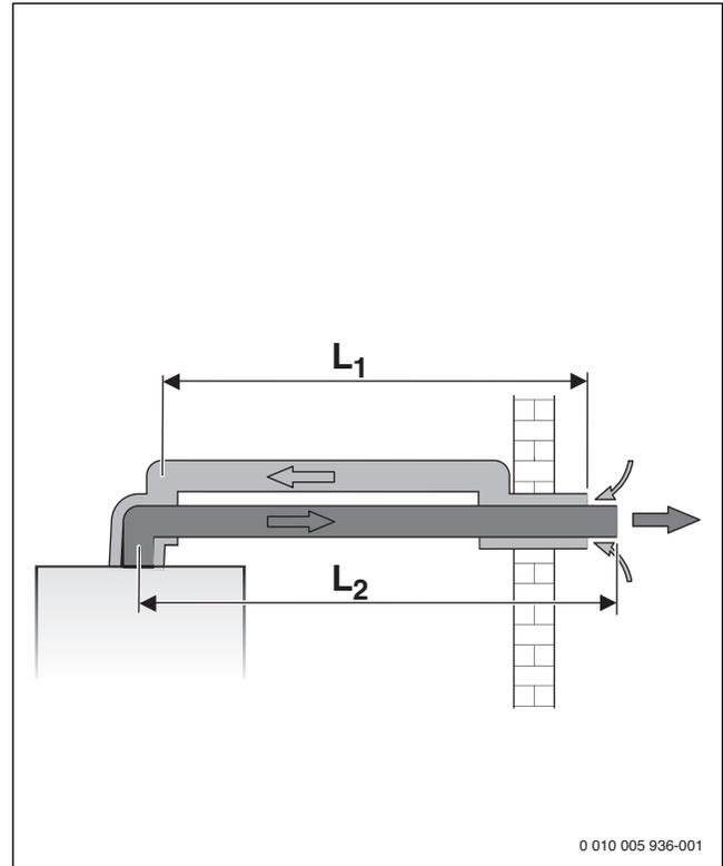
Рис. 7 Горизонтальный отвод дымовых газов через отдельную трубу C<sub>12</sub>
