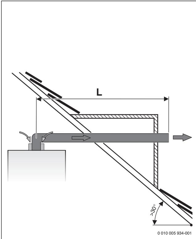
Рис. 4 Горизонтальный отвод дымовых газов В<sub>22</sub>
