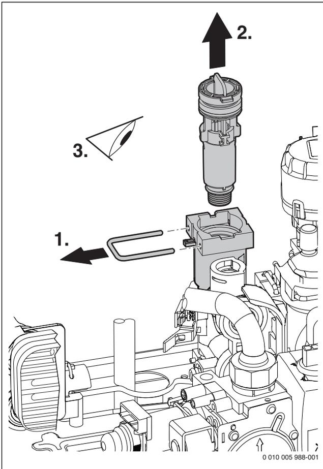
Рис. 31 Проверка фильтра в трубе холодной воды
