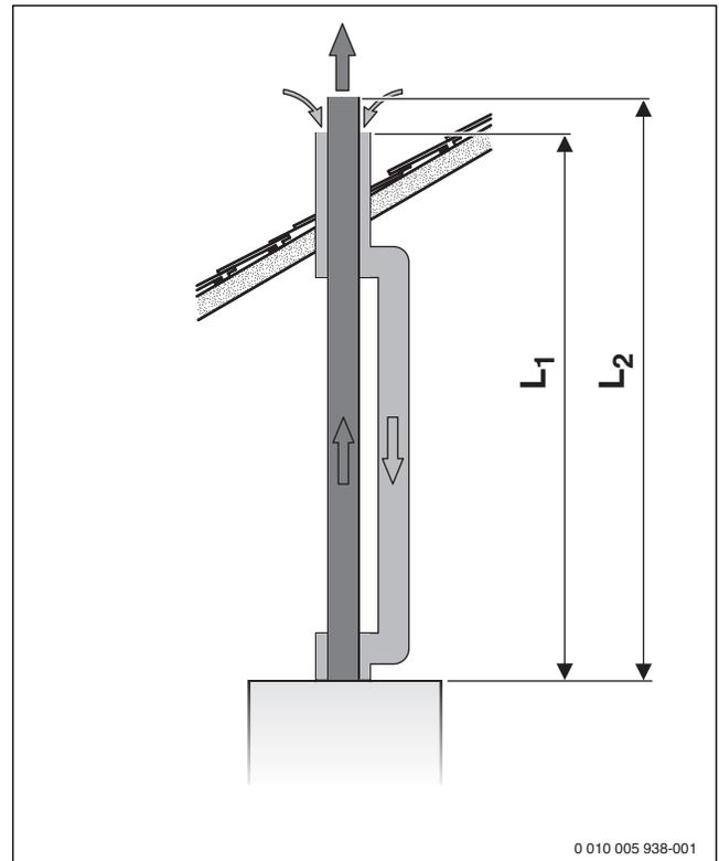
Рис. 9 Вертикальный отвод дымовых газов через отдельную трубу C<sub>32</sub>
