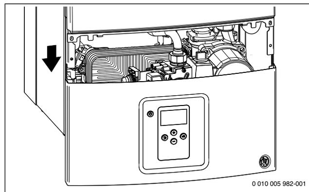
Рис. 26 Подвешенный на раме блок управления для одновременной работы с газовой арматурой
