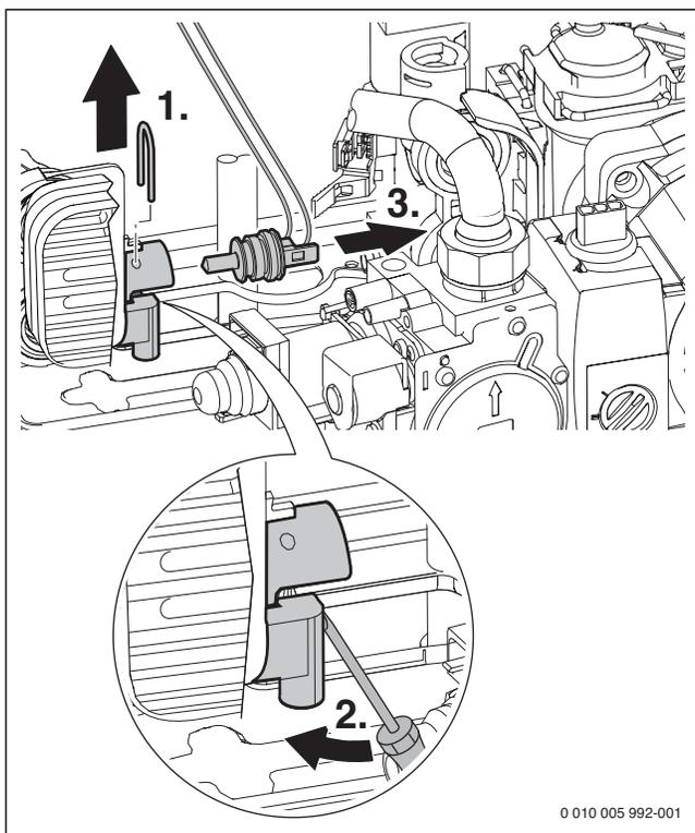
Рис. 35 Демонтаж датчика температуры горячей воды
