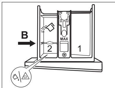
Положення **B** перегородки дозатора призначено для порошкового миючого засобу в задньому відділі та для рідкого миючого засобу, добавки або відбілювача в передньому відділенні.
