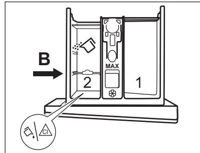
**Положение В** перегородки для моющих средств предназначено для порошковых моющих средств в заднем отделении, а также для жидких моющих средств/добавок или отбеливателя в переднем отделении.
