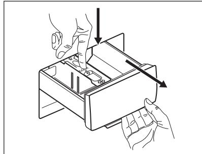
2. Зніміть верхню частину відділення для добавок, щоб полегшити процес очищення, та промийте її проточною теплою водою, щоб видалити залишки муючого засобу. Після очищення поверніть верхню частину на місце.
