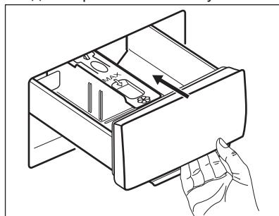
Стежте за тим, щоб перегородка дозатору миючих засобів була правильно встановлена і не блокувала лоток під час зачинення.
