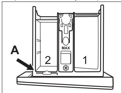
2. Використання також рідкого миючого засобу, добавки або відбілювача. Змістіть перегородку дозатора миючого засобу з положення **A** та вставте в положення **B**.
