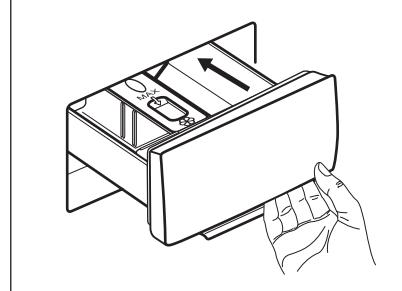
4. Установите дозатор моющих средств на направляющие и закройте его. Запустите программу
