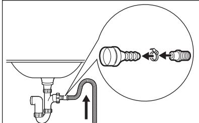
Переконайтесь в тому, що зливний шланг формує петлю для попередження потравляння часточок з раковини до приладу.
