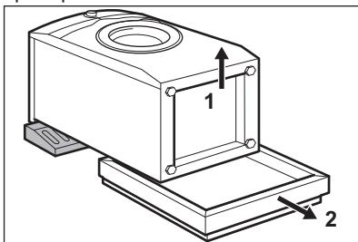
6. Снимите крышку для днища с верхней части прибора. Установите крышку на днище прибора при помощи защелок, которые находятся в пакете с руководством пользователя.
