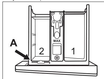
2. **Также для использования жидкого моющего средства/ добавок или отбеливателя:** Извлеките перегородку для моющих средств из положения **A** и вставьте ее в положение **B**.
