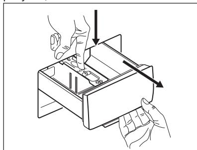
2. Для упрощения очистки снимите верхнюю часть отделения для добавок и промойте его под струей теплой воды, чтобы удалить все следы скопившегося моющего средства. После очистки установите верхнюю часть обратно на место.
