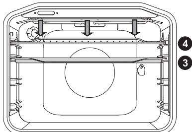
При великому грилі включаються верхній нагрівальний елемент і інфранагрівач, що розташовані під стелею духовки.
