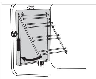
**2** Повісіть спрямовувачі разом з панелями в гнізда та підштовхніть вгору.
