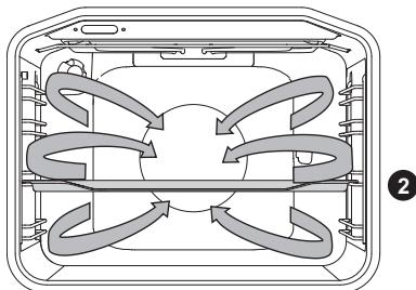
Одночасно працюють нагрівальний елемент навколо вентилятора і вентилятор. Вентилятор забезпечує циркуляцію гарячого повітря навколо м'яса або випічки.
