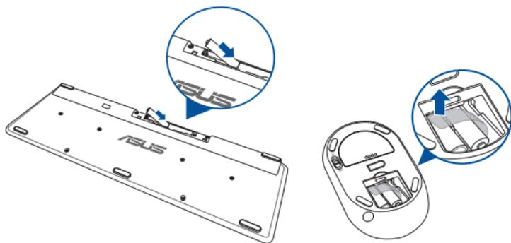
2. Подключите приемник для клавиатуры и мыши к порту USB для автоматического сопряжения обеих устройств с моноблоком.
