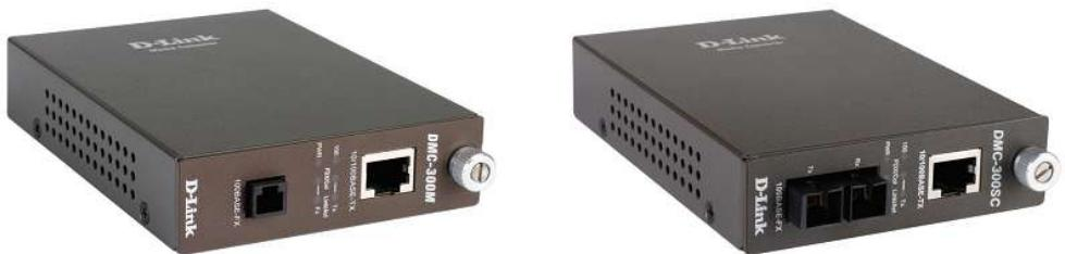
Эти медиаконвертеры преобразуют сигнал из стандарта 10BASE-T/100BASE-TX FastEthernet на витой паре в сигнал стандарта 100BASE-FX FastEthernet по многомодовому оптическому кабелю. Максимальная длина оптического кабеля: 2 км. Устройство оснащено 1 портом RJ-45 для витой пары и 1 оптическим портом.
