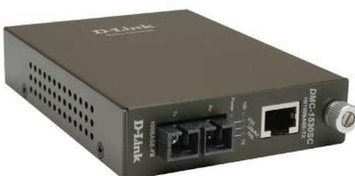
Данный медиаконвертер поддерживает интеллектуальные функции, такие как LLCF, LLR, механизм store-and-forward, управление потоком по стандарту 802.3x и метод «back-pressure». Медиаконвертер преобразует сигнал из стандарта 10BASE-T /100BASE-TX FastEthernet в витой паре в сигнал стандарта 100BASE-FX FastEthernet по одномодовому оптоволокну. Максимальная длина оптического кабеля – 30км. Устройство оснащено 1 портом RJ-45 для витой пары и 1 оптическим портом с разъемом SC.
