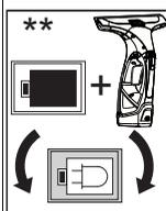
Výměnný akumulátor a přístroj vložte současně do nabíjecí stanice
