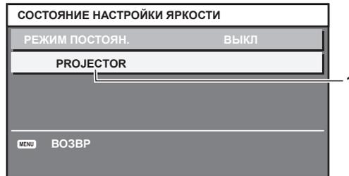
Когда для параметра [РЕЖИМ ПОСТОЯН.] установлено значение [АВТОМАТИЧЕСКИ], а для параметра [ВЗАИМОСВЯЗЬ] установлено значение [ВЫКЛ]
