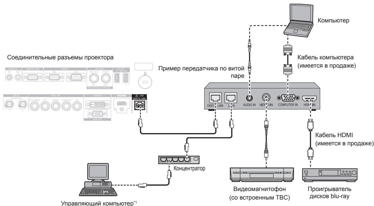
\*1 Объект управления – проектор или передатчик по витой паре. Управление может быть невозможно в зависимости от передатчика по витой паре. См. инструкции по эксплуатации подключаемого устройства.
