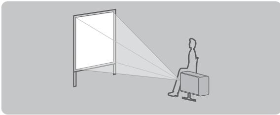
Установка в вертикальном положении и проецирование сзади
