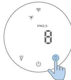
**Автоматичний режим (Ⓐ):** очищувач повітря автоматично налаштовує швидкість вентилятора відповідно до якості повітря навколо.
