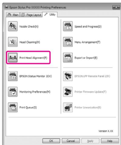
Сенсор считывает калибровочный шаблон в процессе его распечатки и автоматически устанавливает оптимальные калибровочные величины.
