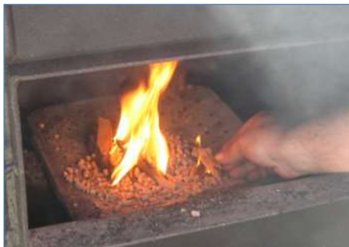
Малюнок 12. Ручне розпалювання палива в котлах версії RK3G/S
