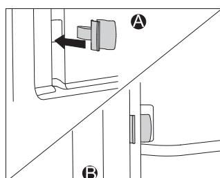
При установці телескопічних спрямовувачів, що повністю висуваються, з панелями EasyClean встановіть фіксатори (додаються в комплекті) в отвори в нижній частині бічних стінок духовки. Заклацніть спрямовувачі в фіксаторах. Фіксатори забезпечують більш надійну установку спрямовувачів.
