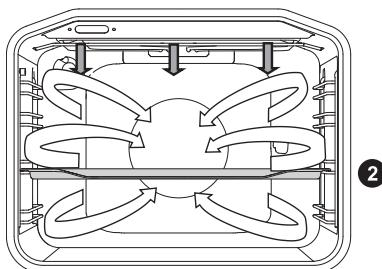
Одночасно працюють верхній нагрівальний елемент, інфранагрівач і вентилятор. Призначений для приготування м'ясо, риби, овочів.
