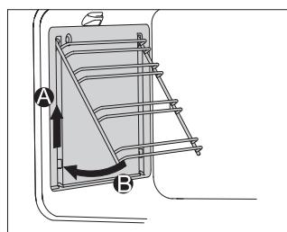
**2** Повісьте спрямовувачі разом з панелями в гнізда та підштовхніть вгору.
