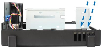
**b** Установите диск в отсек для дисков и продвиньте вперед, пока он не подключится к разъему SATA.
