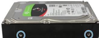
**a** Установите крепежную скобку жесткого диска в NVR, затем зафиксируйте скобку с помощью винтов, входящих в комплект поставки.
