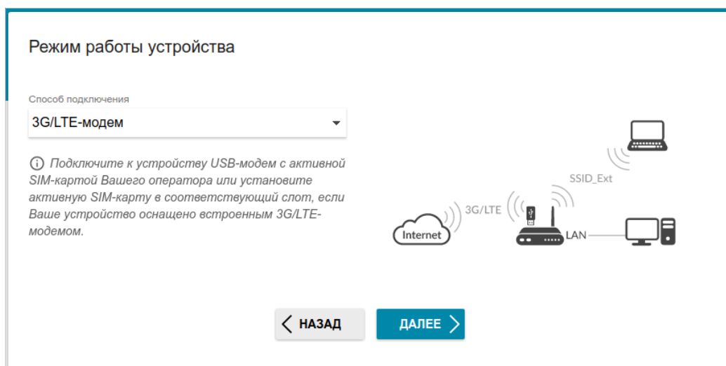
Рисунок 26. Выбор режима работы устройства. Режим 3G/LTE-модем .
