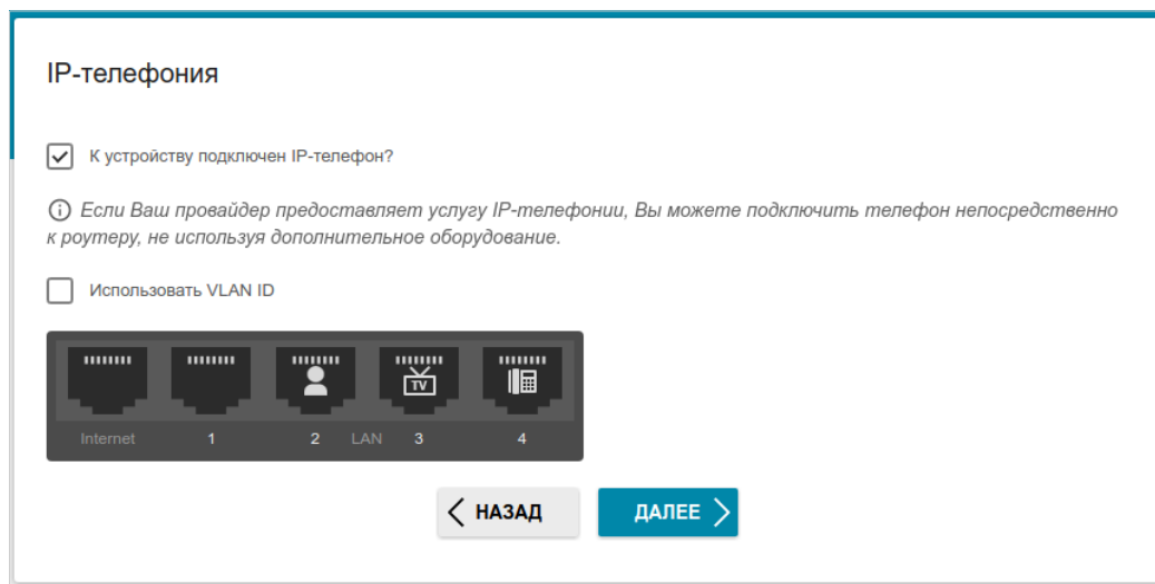
Рисунок 40. Страница выбора LAN-порта для подключения VoIP-телефона.
