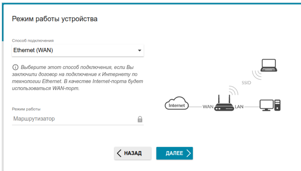
Рисунок 25. Выбор режима работы устройства. Режим Ethernet (WAN) .
