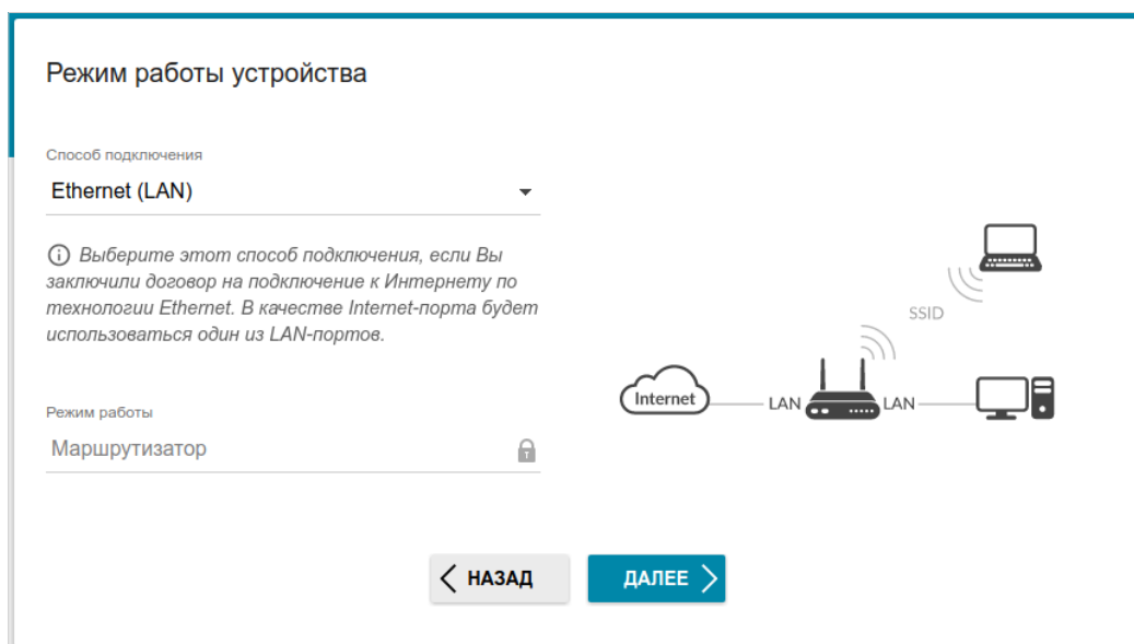
Рисунок 27. Выбор режима работы устройства. Режим Ethernet (LAN) .
